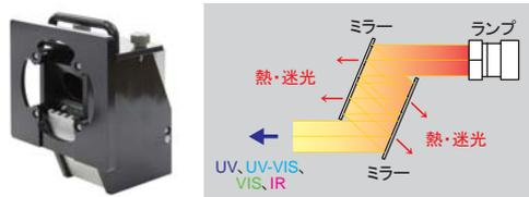
ミラーモジュールとは、紫外域もしくは可視域だけを反射する多層膜を組み合わせて、所望の波長帯の光のみを取り出すことのできるモジュールです。有害な熱を抑え、かつ迷光レベルも極端に少なくする性能もあります。
